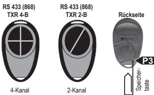
Der Empfänger prüft das ankommende Sendersignal auf richtige Codierung, bevor der Befehl weitergeleitet wird. Hierzu muss die Sendertaste ca. 1-2 Sekunden betätigt werden.
