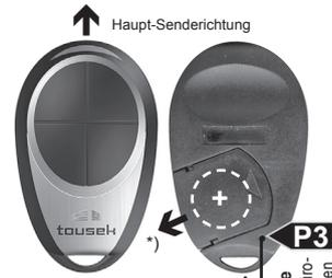
\*) Zum Batteriewechsel öffnen Sie die Handsender-Rückseite und setzen eine neue 3V-Lithium Batterie CR2032 mit Plus-Pol nach oben ein.
