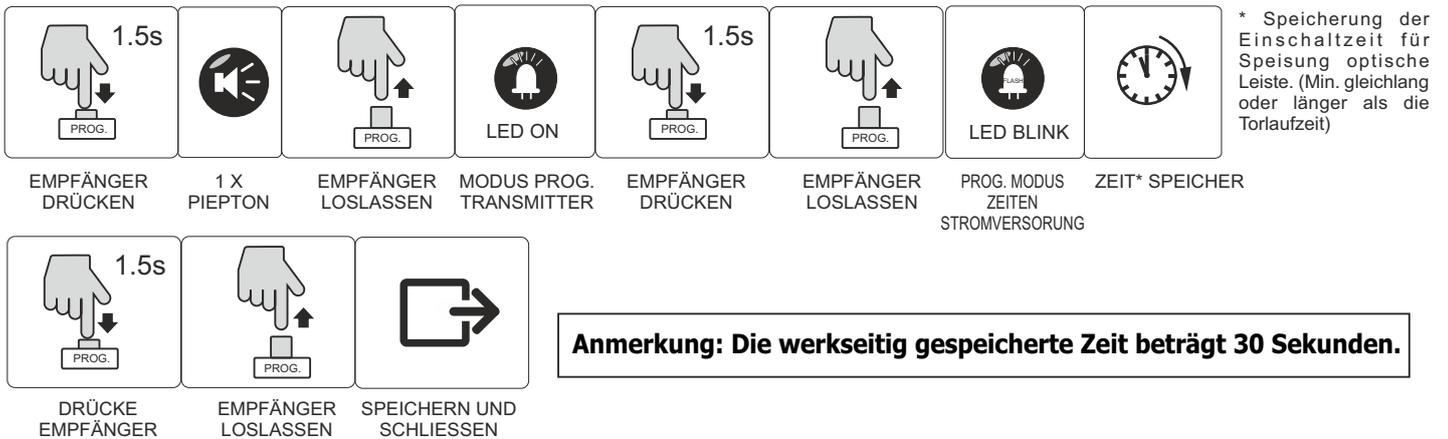
**4.2 VERZÖGERUNG DER OPTISCHEN LEISTE VOM EMPFÄNGER AUS: (KONTAKT POSITIONIERUNG N.C. oder N.O. VERWENDEN)**
