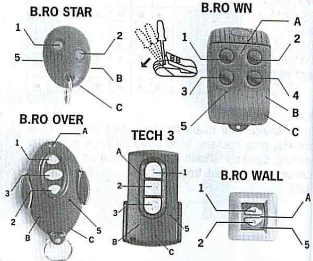
Zum Öffnen B.RO WN des Batterie-fachs drücken Sie bitte leicht mit einem Schraubenzieher auf den angegebenen Punkt. Zum Schliessen die Batteriehalterung leicht zusammendrücken und zuerst die untere Deckelseite einrasten.
