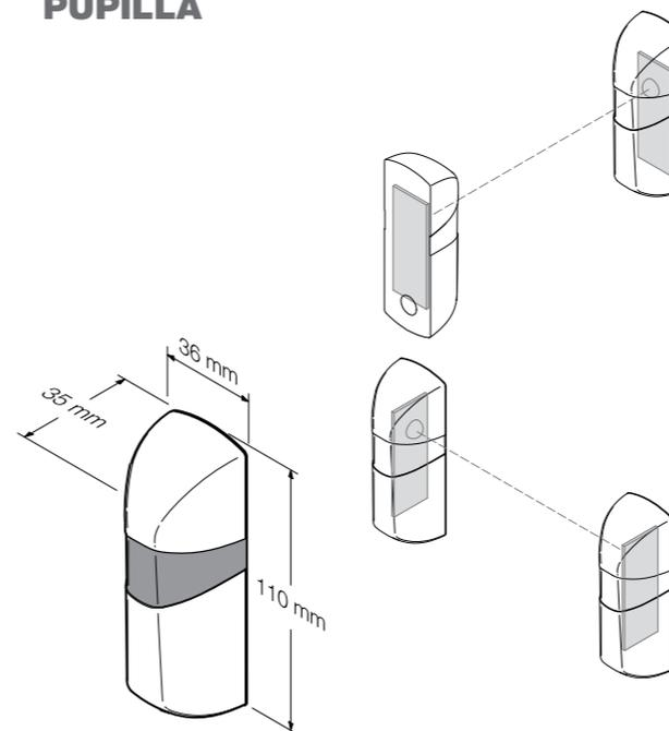
Die Möglichkeit des Schwenkens um 180° ermöglicht die Ausrichtung der Lichtschraken, unabhängig von der Befestigungsart der Basis.
