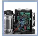
Steuerung mit eingebautem 433,92 Mhz Funkempfänger 64 Speicherplätze unh halbautomatische Betriebslogik
